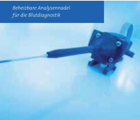
Komplexe Blutflusszelle für die Hämoglobinbestimmung in Point-of-Care-Geräten
